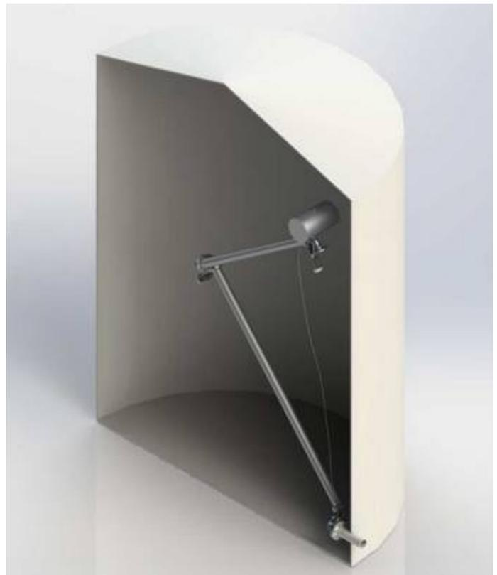
Le bras suit les variations de niveau grâce au flotteur en obtenant ainsi l'aspiration du produit propre à la surface
