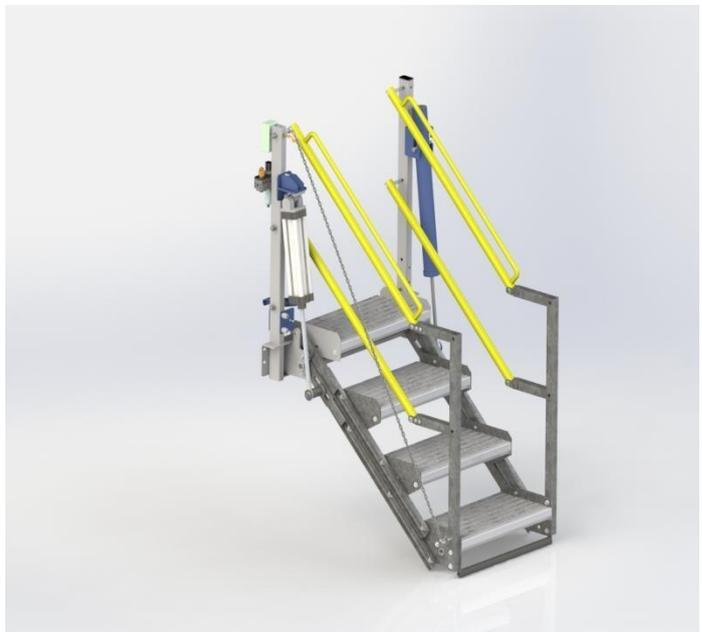
Le mouvement de montée et descente de la passerelle à abattant est assuré soit manuellement, soit avec une assistance par vérin pneumatique. **PACQUET SOLUTIONS D'EMPOTAGE** vous recommande de prendre l'option assistance pneumatique pour les arceaux dont la largeur excède les 2,8m.
