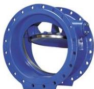
Clapet anti-retour à joint métallique avec siège incliné pour réduire le temps de fermeture. En option, amortisseur de fin de course interne pour réduire les coups de bélier. Pour une bonne performance, la vitesse d'écoulement doit être de 1,5 m/s minimum.
