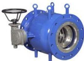
Vanne de régulation à piston avec section de passage circonférentiel (annulaire) destinée au réglage continu de pression et de débits élevés, commande par volant ou actionneur.
