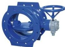
Vanne-papillon à bride, clapet à double excentricité, corps avec revêtement époxy, commande par réducteur, actionneur ou vérin hydraulique avec contrepoids.
