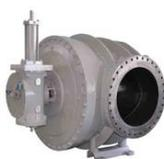
Robinet d'arrêt à joint métallique avec passage intégral, faibles pertes de charge. Le boisseau sphérique est décollé du siège avant rotation.
