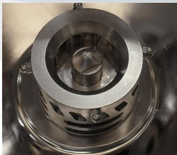
Rotor/stator à fort cisaillement
